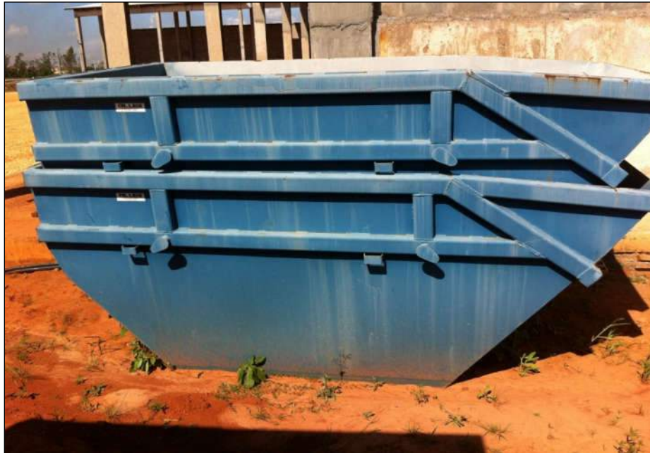
Figura 3.84 – Caçamba para acondicionamento do lodo desidratado.
